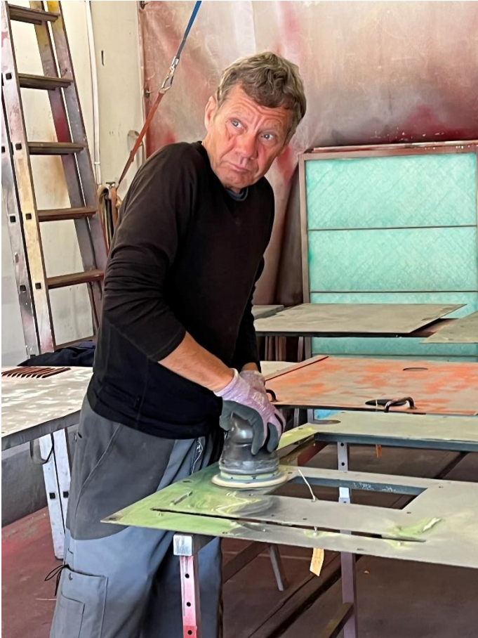
Markus Lacher beim Schleifen der Abdeckbleche des Schienentraktors Tm 2922 «Tuk-Tuk» in der Werkstatt der Dieselcrew.
