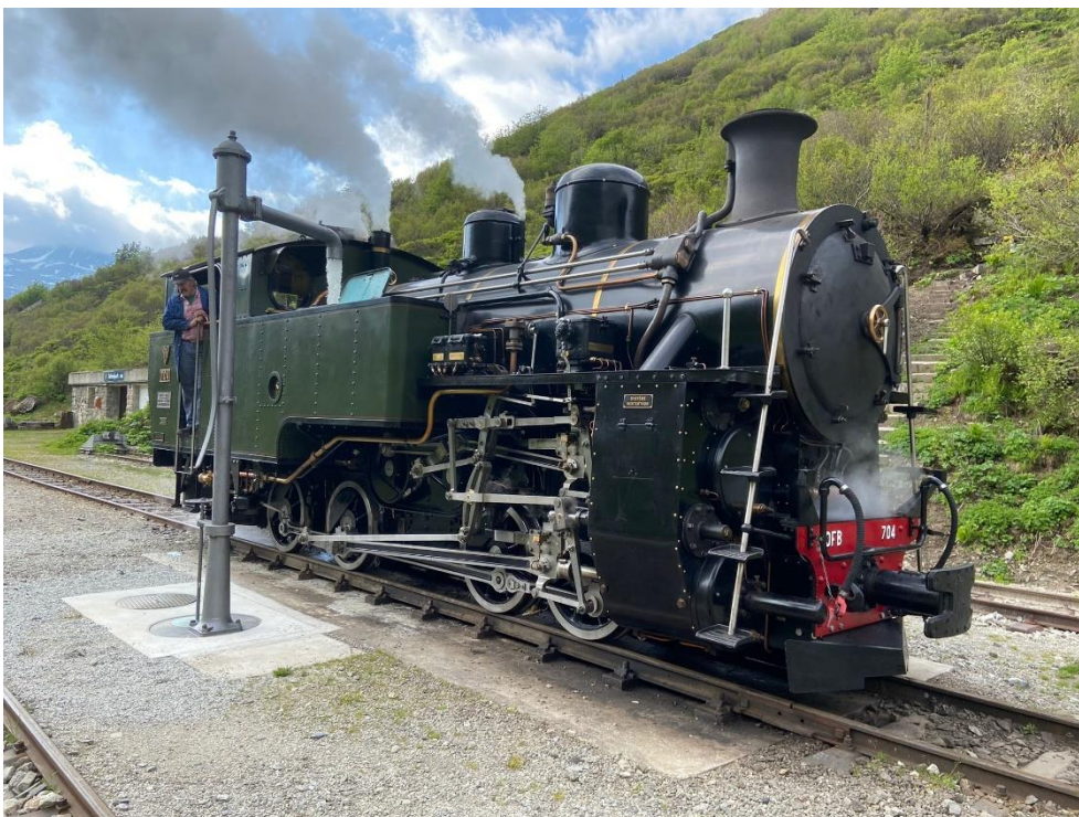
Die HG 4/4 704 beim Wasserfassen mit dem neuen Wasserkran in Tiefenbach.
